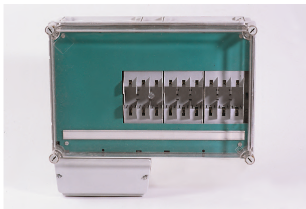
Verteiler mit 3x NH-Reiter-Sicherungsunterteil NH00
