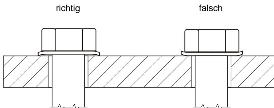
Überprüfen Sie die verwendeten Schrauben auf passende Längen, um unzulässige Kriech- und Luftstrecken sicher auszuschließen.
